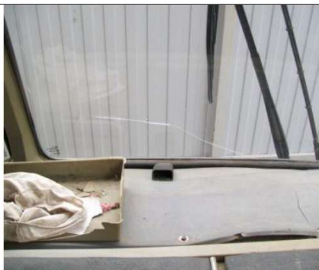
ПАЗ-32053-70, Трещина лобового стекла
