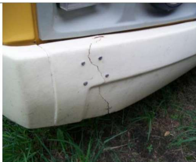
ПАЗ-32053-70, Трещины в бампере
