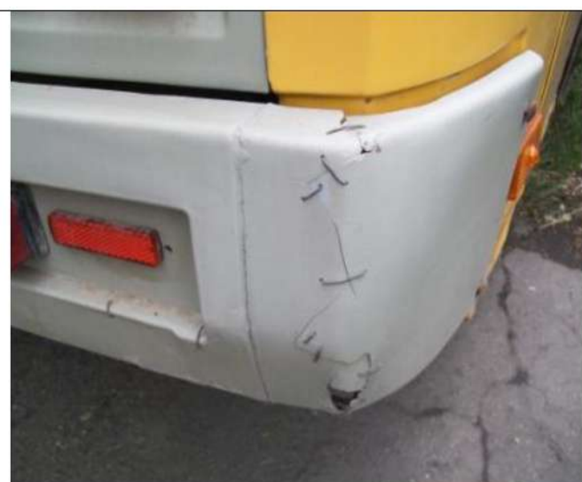
ПАЗ-32053-70, Трещины в бампере
