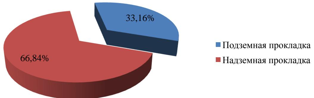
Рисунок 2.3.2.1 – Доли протяженности участков трубопроводов тепловых сетей от котельных ООО "Тепловая компания" различных видов прокладки
