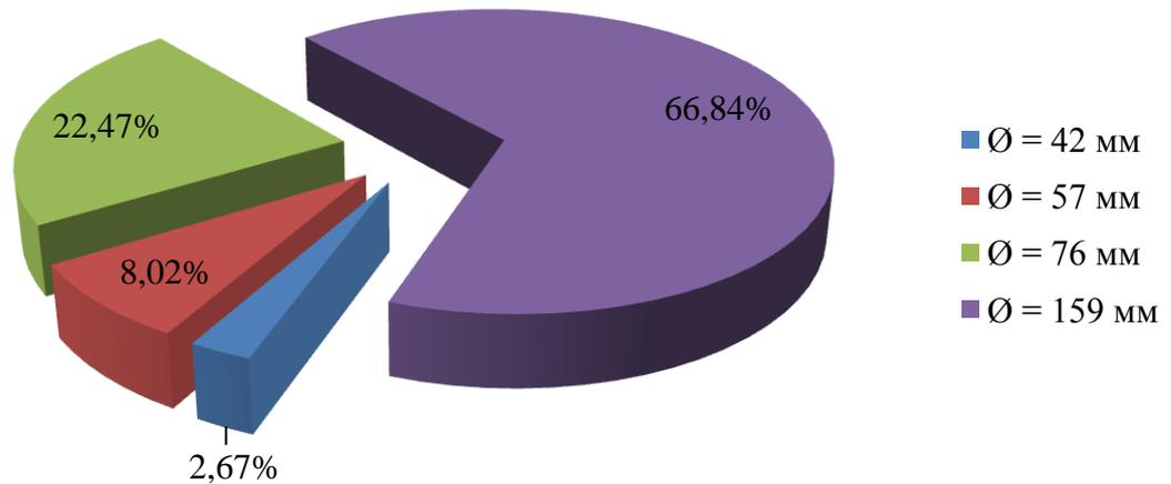
Рисунок 2.3.2.2 – Доли протяженности участков трубопроводов тепловых сетей котельных ООО "Тепловая компания" различных диаметров
