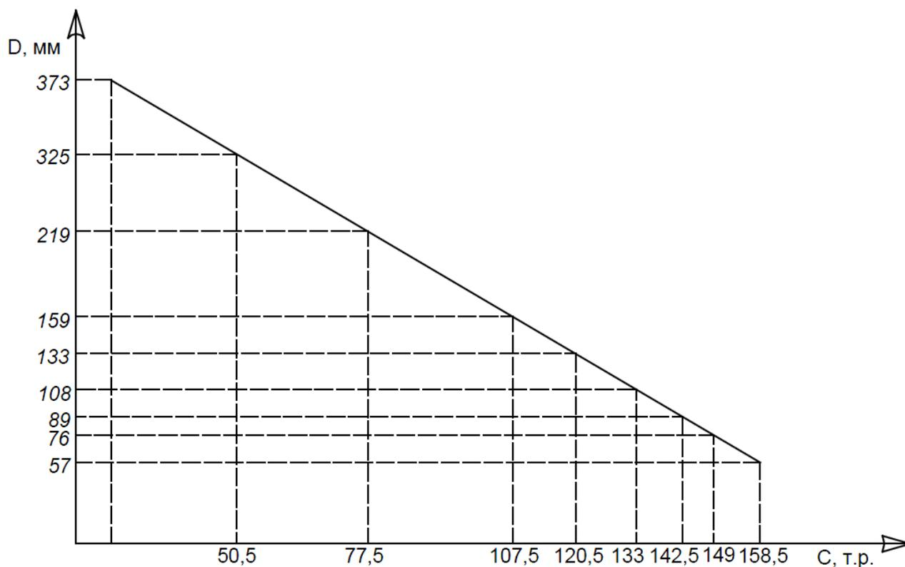
Рисунок 7.7 – Зависимость стоимости одного м<sup>2</sup> материальной характеристики от диаметра трубопровода
