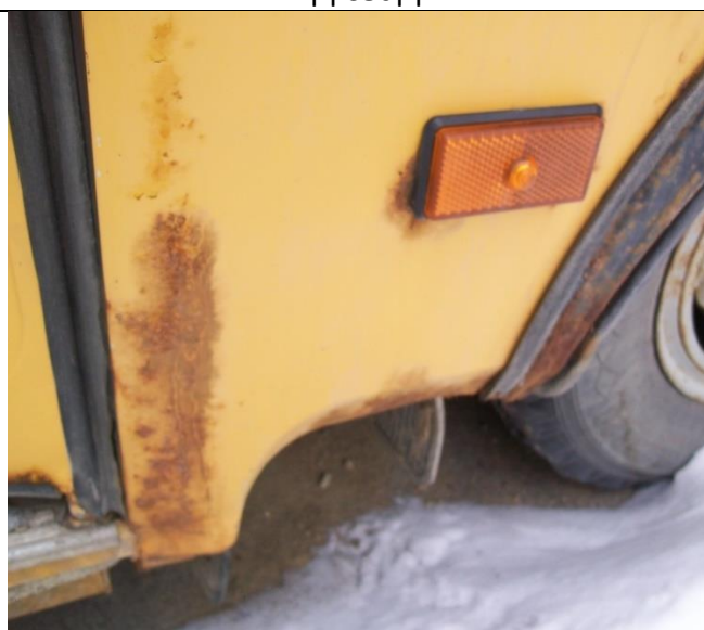
ПАЗ-32053, Коррозия на крыльях
