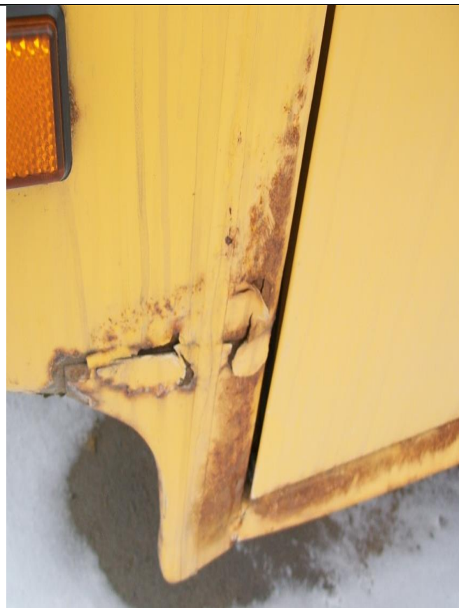
ПАЗ-32053, Состояние порогов, крыльев
