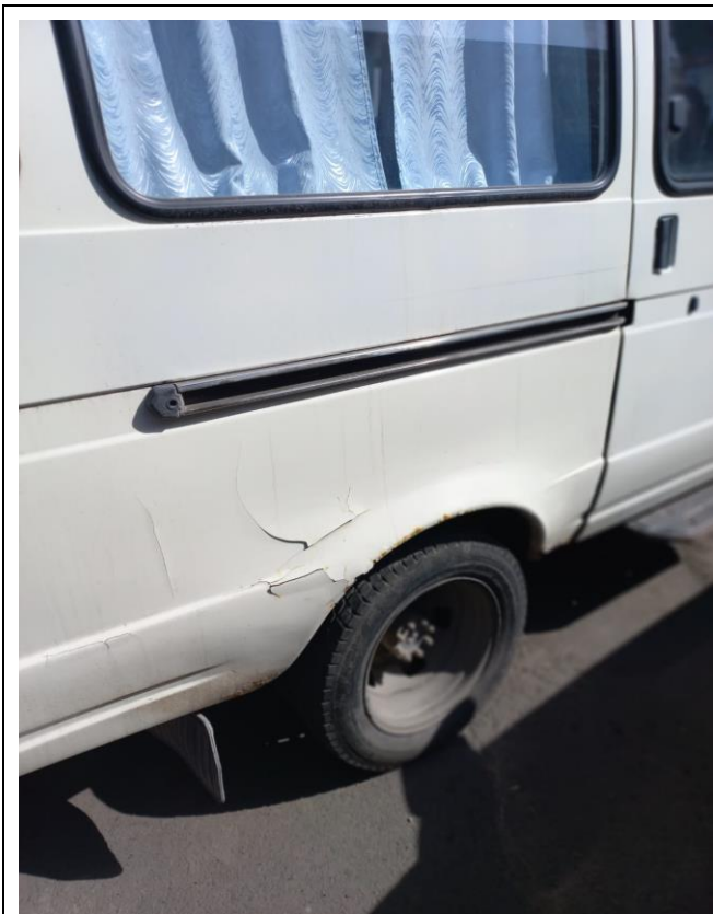
ГАЗ-322132, Повреждение кузова
