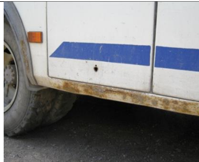
ПАЗ-32053, Коррозия крыльев и порогов
