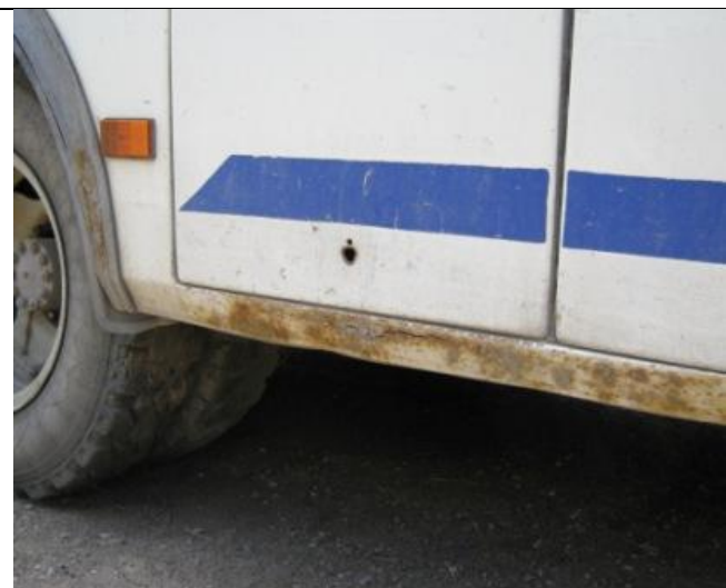
ПАЗ-32053, Коррозия крыльев и порогов
